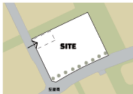
도로 위치에 따라 차량 출입구 및 서비스 동선 계획 도로쪽에 녹지 조성하여 소음 차단
