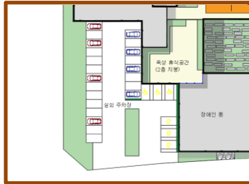
주진입로와 인접하게 장애인 전용주차구역6개 설치
